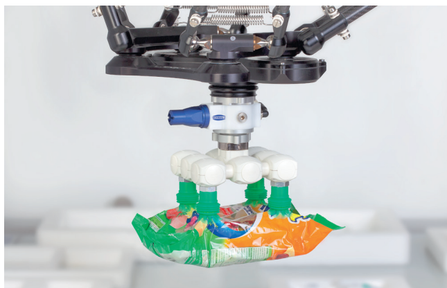
Vakuu-Endeffektor VEE mit Balgsauggreifern SPB4f bei der Handhabung von Beutelverpackungen mit starker Faltenbildung und geringem Füllgrad
